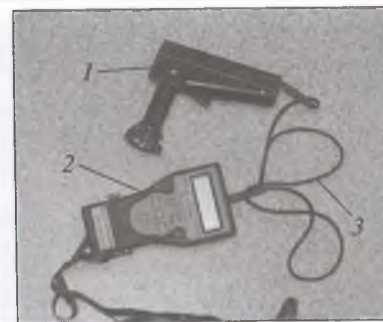
Рис. 7.3. Склерометр ИПС-МГ4.03 ударно-импульсного типа:
