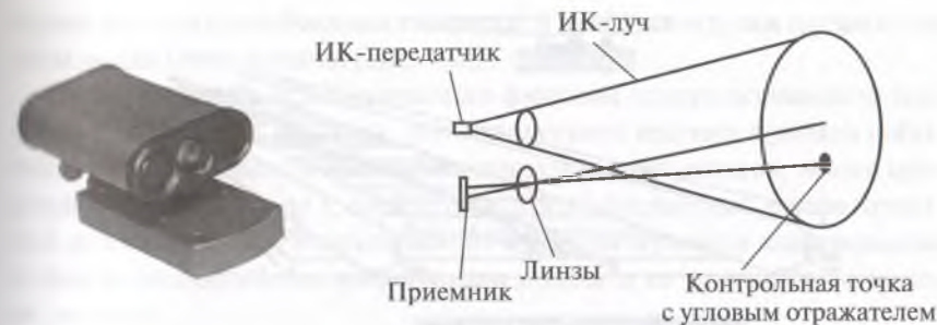
Рис. 4.19. Оптический датчик и схема работы системы оптического мониторинга
